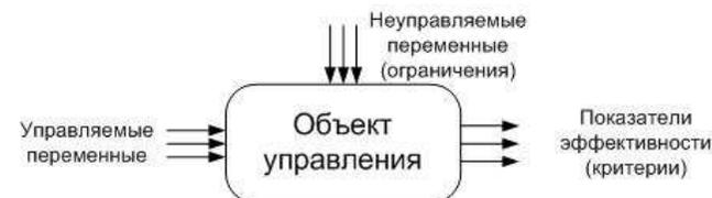
Рис.2.1-1. Схема построения математической модели для объектов управления («черный ящик»).
